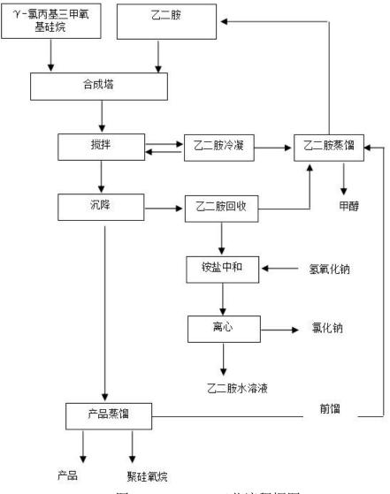
图 2.1-6 KH-792 工艺流程框图
