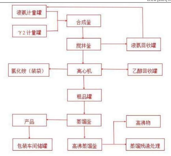
图 2.1-2 KH-550 工艺流程框图
