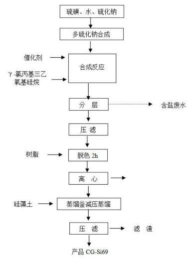
图 2.1-7 CG-Si69 工艺流程框图
