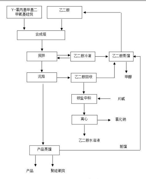
图 2.1-5 CG-602 工艺流程框图
