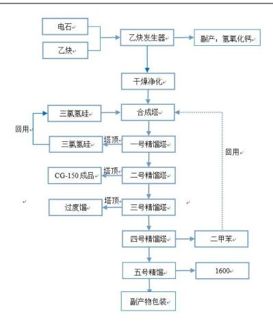
图 2.1-1 CG-150 工艺流程框图
