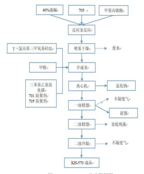
图 2.1-4 KH-570 工艺流程框图
